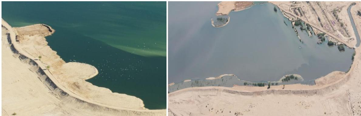
Figura 5. Cama D, a la izquierda con el nivel alto a la derecha un vez que se le bajó el nivel y se pudo plantar tule. Se observa a la derecha el 5% donde no fue posible bajar el nivel para plantar tule. Como referencia se pueden observar los dos mismos árboles sobre el bordo en cada una de las fotos.
