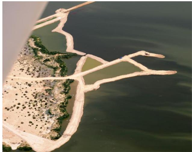
Figura 8. Cama G en construcción a la izquierda y actualmente a la derecha, los bordos son muy anchos y tienen un nivel muy alto – puede transitar un vehículo.
