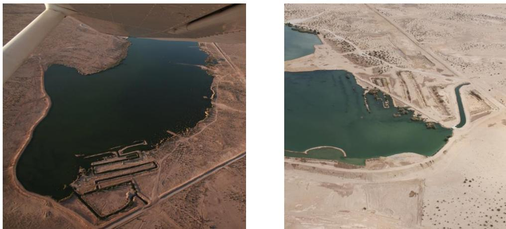
Figura 11. Sección sur del humedal en donde el canal de salida (fotografía de la izquierda) fue modificado por la CESPM para sólo tener un canal en línea recta como se muestra en la fotografía de la derecha.
