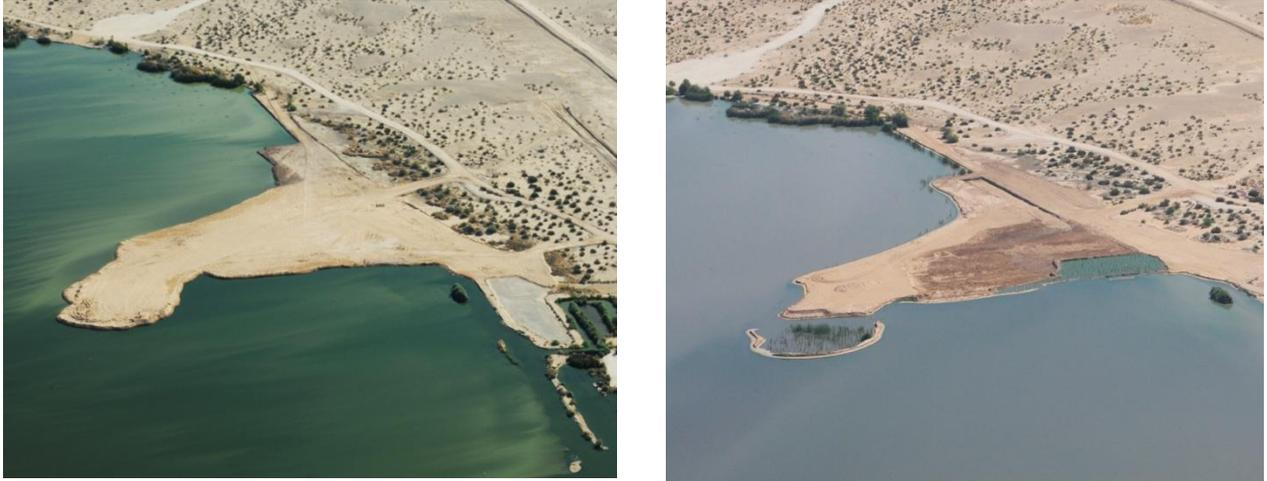
Figura 4. Cama C después del movimiento inicial de material (izquierda, marzo 2011) y después de la remoción de material para adquirir el nivel necesario para plantación de tule (derecha, marzo 2012).
