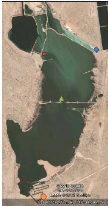
Figura 22. Ubicación de los puntos de monitoreo de calidad del agua en el humedal (◆) Efluente general, (■) Celda 1-2, (▲) Celda 2-3 y (●) Salida humedal. Sonda de medición continua YSI al sur de la Celda 3.
