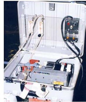
Equipo de producción de hipoclorito dentro de una corriente de agua
