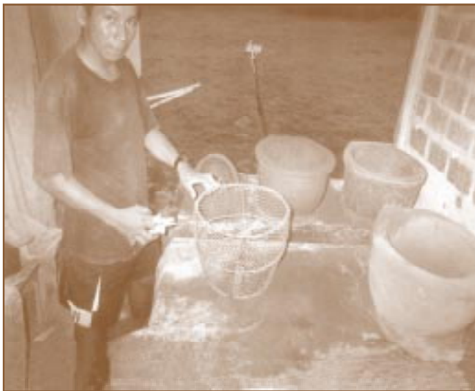
Tasa sanitaria de ferro cemento
