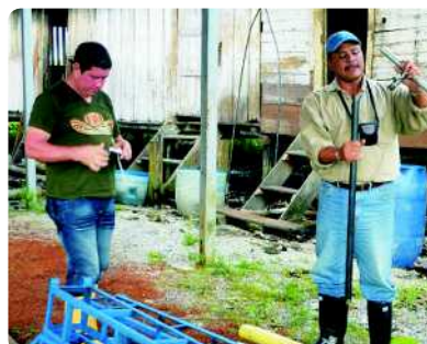
Armado de la barra de perforación y su acople a la manija de rotación, Municipio de López de Micay, Cauca.
