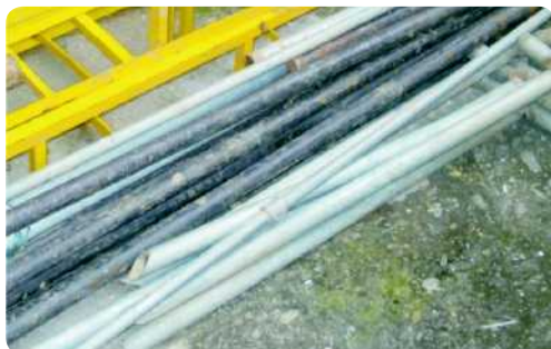
Foto 1: Barras de perforación
