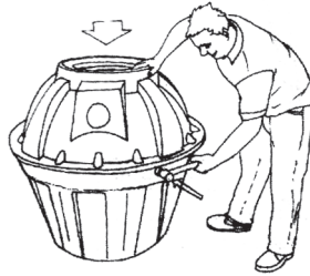
Gráfico 3 Proceso para la unión de los módulos golpeando con un martillo
