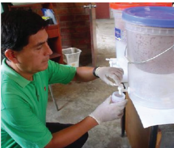
Figura 2-4: Ejemplo de tratamiento intradomiciliario de bajo volumen - el “Filtrón”, un filtro cerámico fabricado y distribuido en el Perú por la empresa Mercantil Interamericana de Lima.
