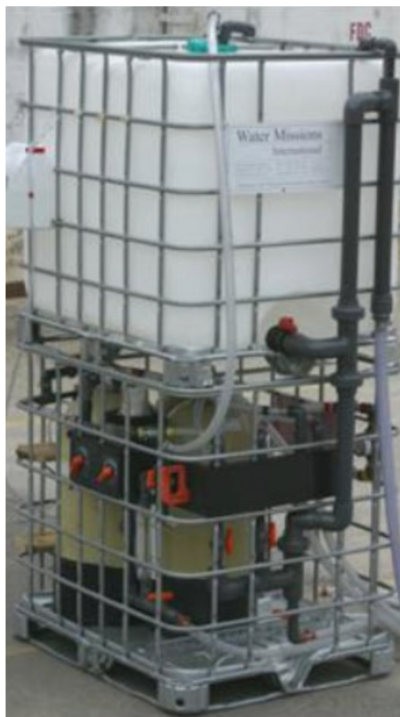
Figura 4-15: Sistema LivingWater utilizado por la ONG Misiones de Agua Internacional con capacidad de hasta 10 galones por minuto. Utiliza un filtro rápido a presión, bombas eléctricas, y cloro en tabletas. Necesita paneles fotovoltaicos donde no hay energía eléctrica.
