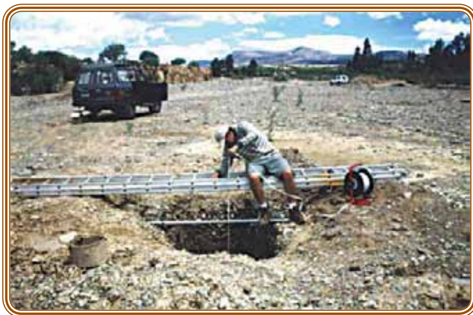
Figura 11 Medición de profundidades, prueba de recuperación de acuífero.
