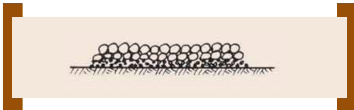
Fig. 6.15 Graduación del tamaño del grano esquematizado a lo largo de la corriente
