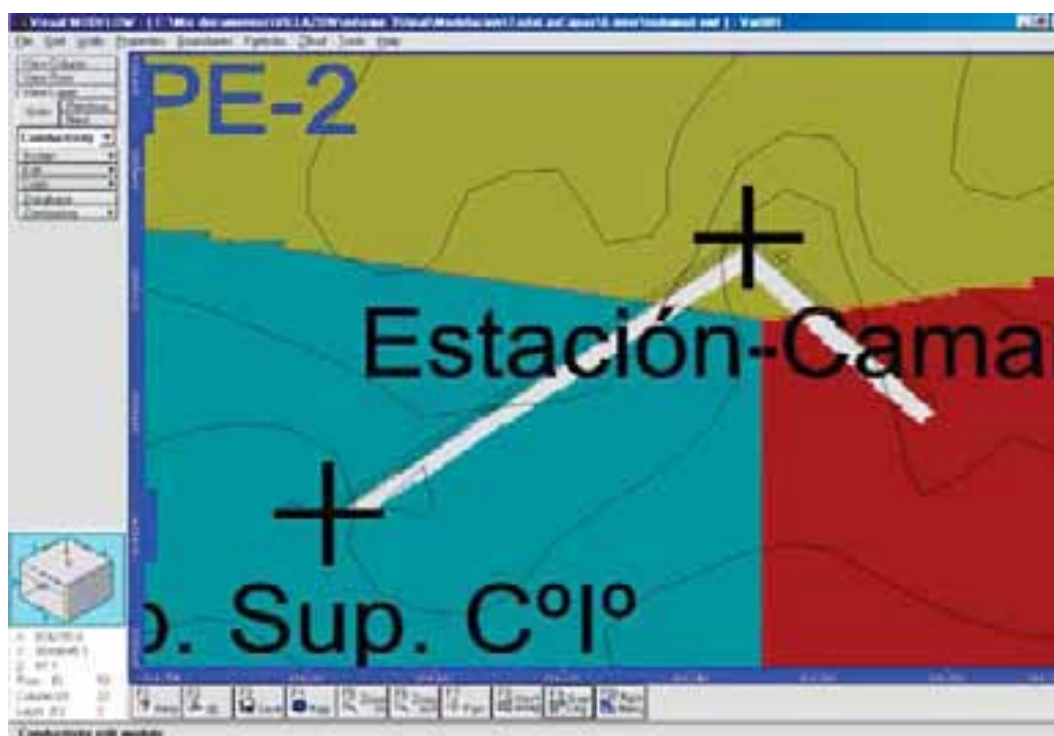
Figura 19 Conductividad hidráulica del filtro
