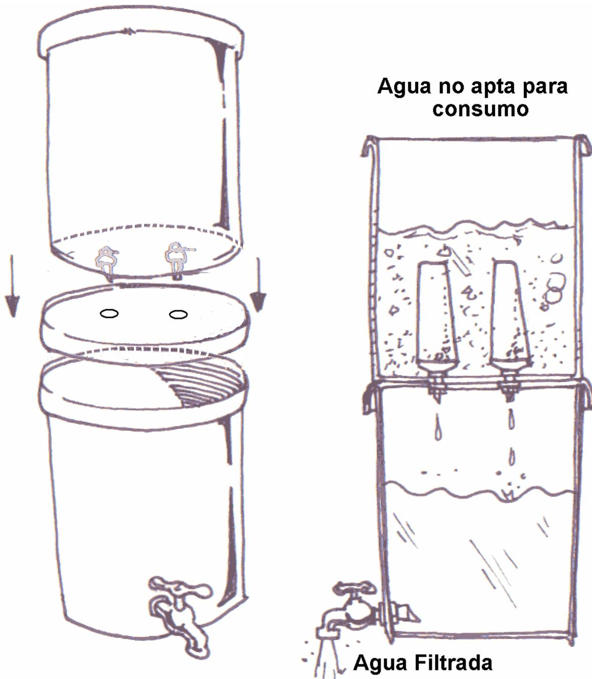
El ensamble del filtro después de todos los pasos que se han descrito, solo requiere que se tape el segundo valde con su tapa que esta fijada al primer valde. Proceda a llenar manualmente el valde superior y espere a que todo el contenido pase al valde inferior, y así obtendrá agua filtrada apta para consumo.
