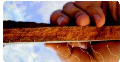
Detalle de la pared filtrante de los filtros de barro, con incorporación en las superficies interna y externa de plata coloidal.
