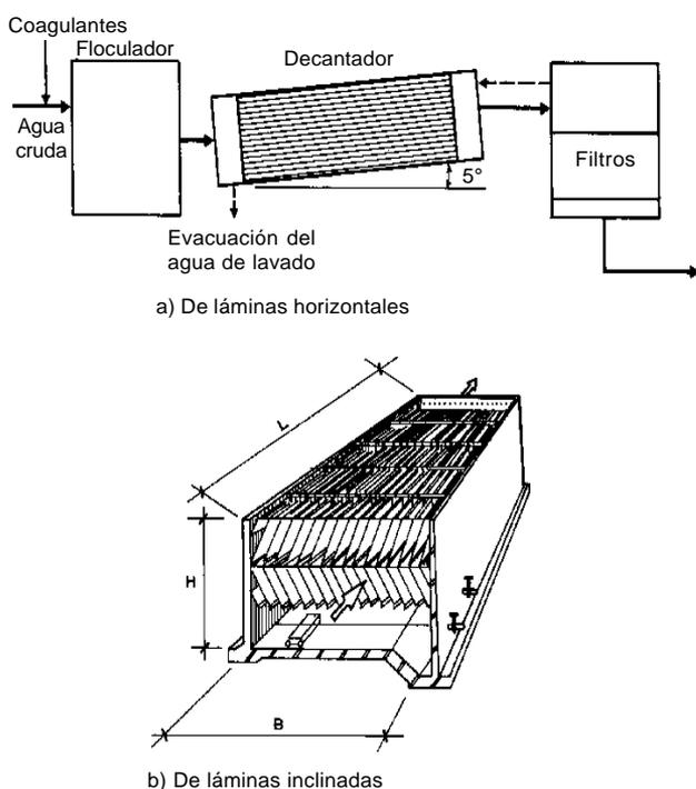
**Figura 7-45.** Decantadores laminares de flujo horizontal (6)
