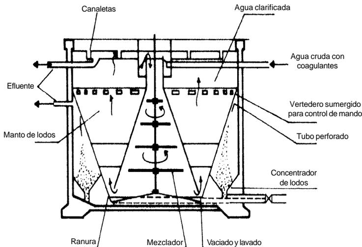
**Figura 7-25.** Unidades de separación dinámica
