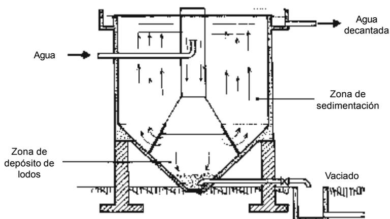
**Figura 7-19.** Sedimentador estático de flujo vertical (1)
