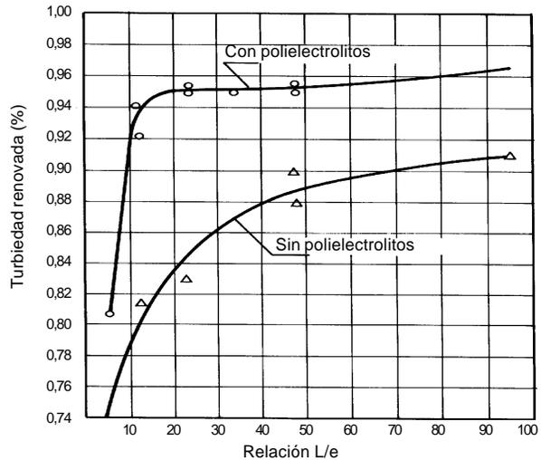
**Figura 7-42.** Eficiencia de los sedimentadores tubulares (2)
