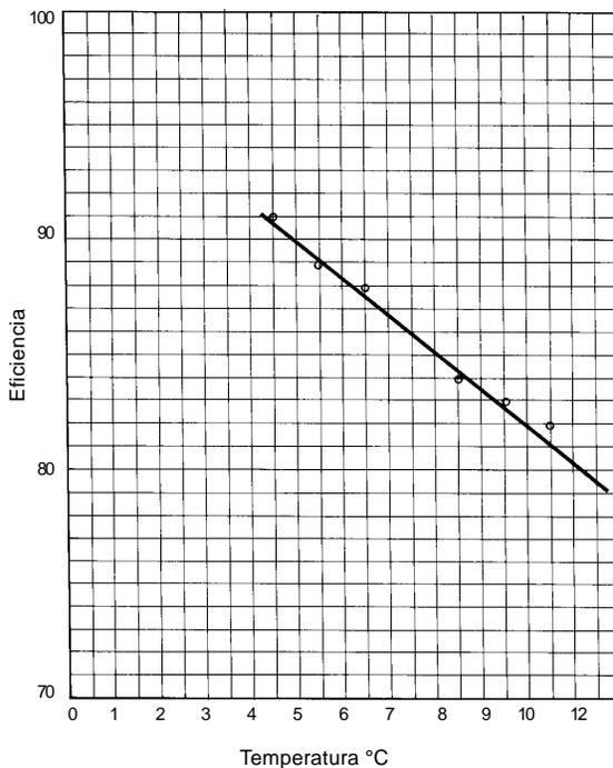
**Figura 7-38.** Influencia de la temperatura del agua en la eficiencia del decantador laminar (4)
