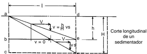
En un sedimentador ideal de forma rectangular y con flujo horizontal, la resultante será una línea recta. Asimismo, otras partículas discretas se moverán en lugares geométricos paralelos. Estableciendo semejanzas entre los triángulos formados por las velocidades y las dimensiones del decantador, donde ( $L$ ) es la longitud y ( $H$ ) la altura, se obtiene:
