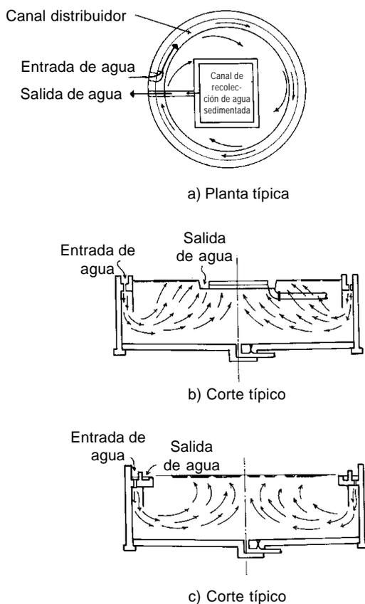
**Figura 7-20.** Sedimentador estático de flujo helicoidal (1)
