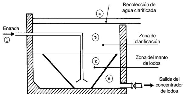
**Figura 7-21.** Componentes de un decantador de manto de lodos (1)
