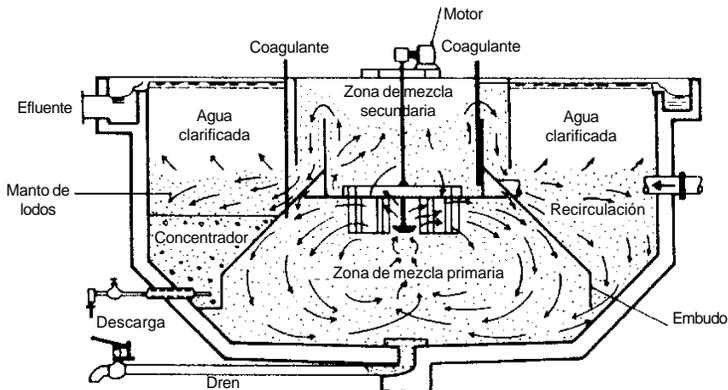
**Figura 7-24.** Unidades de separación dinámica
