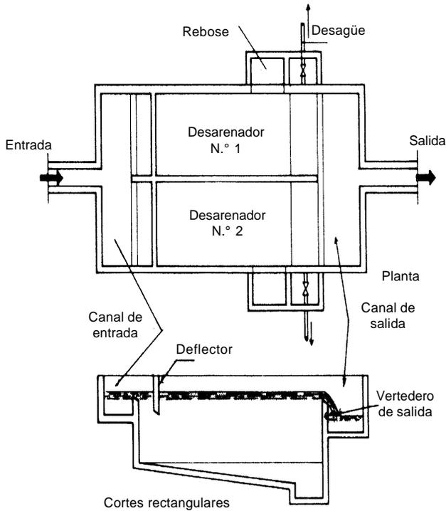
**Figura 7-16.** Desarenador rectangular (1)
