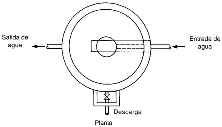
Figura 7-18. Sedimentadores o decantadores estáticos circulares (1)
