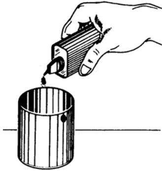
dispositivo de filtración en segunda posición (floja pero en el soporte del filtro).
