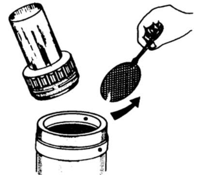
filtración, sujetando su borde con la punta de la pinza.
