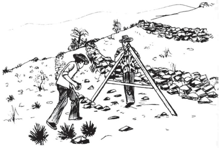
Después hay que calibrar el "Aparato A": En una superficie mas o menos plana, se marcan dos puntos para colocar el aparato: En el travesaño marcamos con un lápiz la posición del plomo, después volteamos el aparato, si coincide la postura del plomo con la marca anterior, esto es el nivel, de otra manera el centro se encuentra exactamente en el medio de la primera y la segunda
