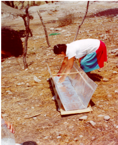
Figura. 15. Concentrador solar para desinfectar agua en 8 botellas.
