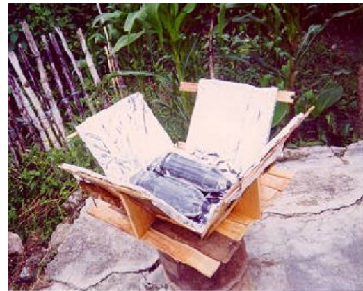
Figura 1. Concentrador de energía solar para la desinfección de agua (Martín, et al., 1999).
