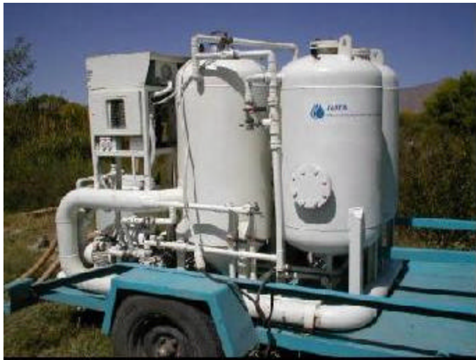
Figura 2. Planta potabilizadora móvil
