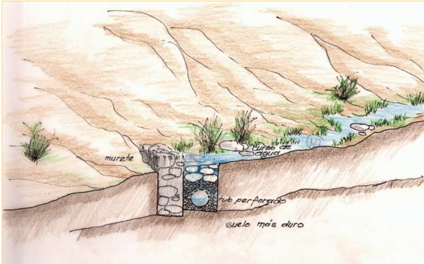
Captación en quebrada mediante muro y caño filtrante.
