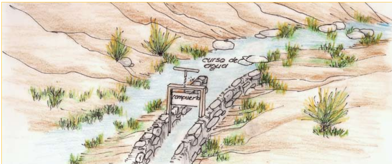
Bocatoma con compuerta de cierre.
