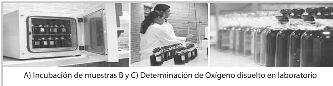
Figura 50. Determinación de DBO_5 en laboratorio.
