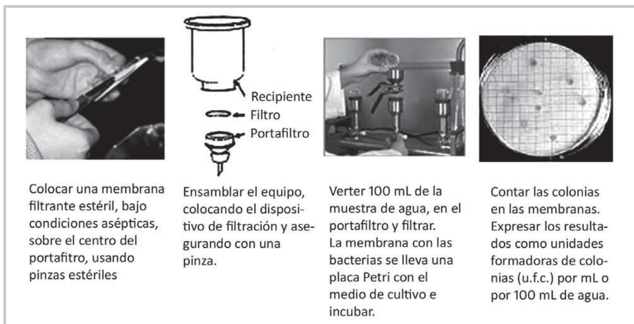
Figura 40. Técnica de la membrana filtrante para la determinación de bacterias.
