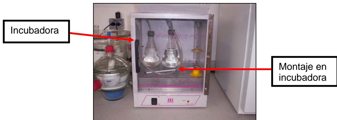
Figura 34. Montaje en incubadora a 35°C. - lodos reactor anaerobio, Colanta
