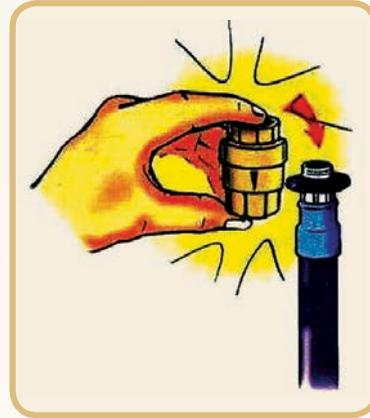
**Segundo Paso.-** Conecte en la parte inferior del politubo de 3/4" de diámetro (pistón) **la nueva válvula del pistón** mediante su rosca.
