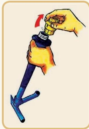
**Primer Paso.-** Desenroscar la **válvula de retención de 1/2"** (válvula de pistón), del politubo de 3/4" de diámetro de pistón.
