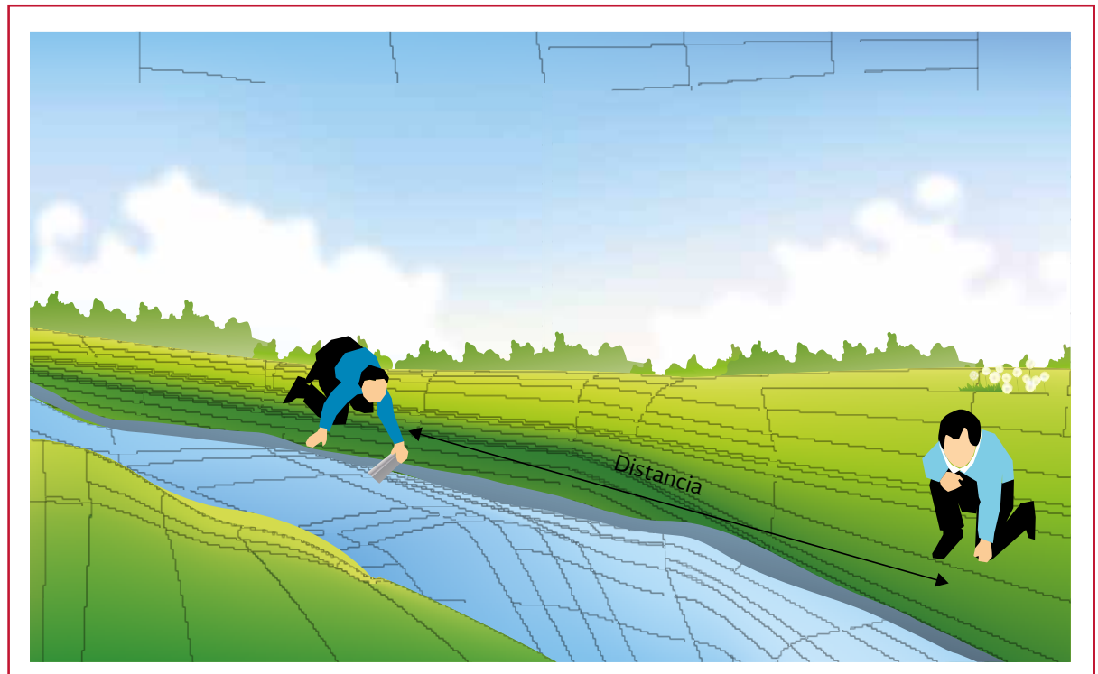
Ilustración 2.5 Método de velocidad-área
