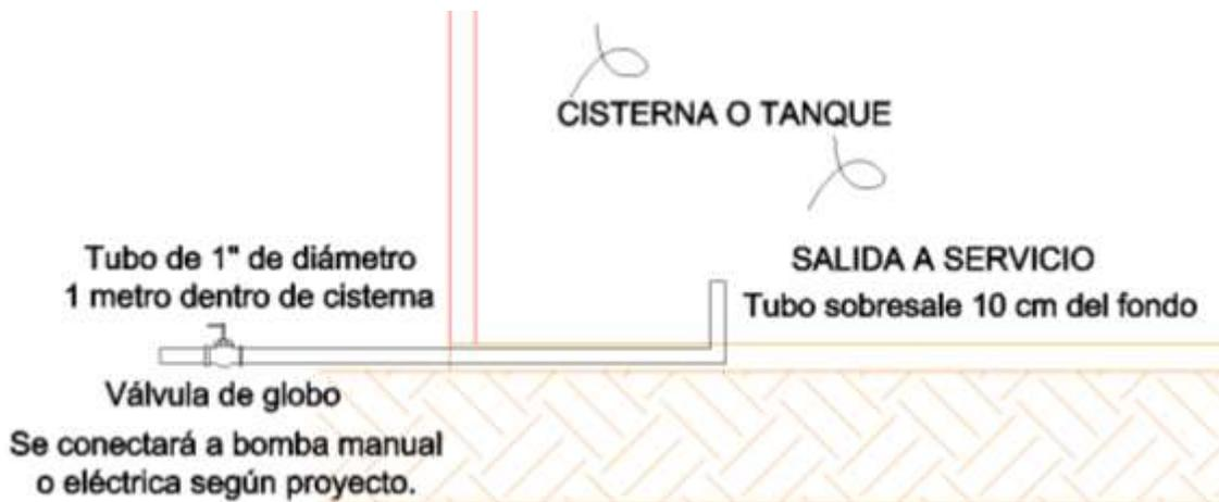
La salida para desfogue de la cisterna con la finalidad de su vaciado completo para labores de limpieza y mantenimiento, se deberá hacer mediante un tubo de 1" colocado al fondo de la cisterna.
