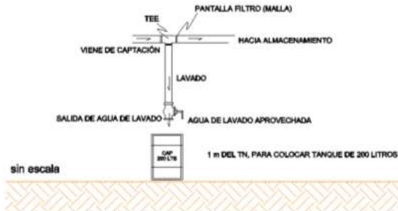
**ARREGLO 3; CUANDO EL CONTROL DE LAVADO SERÁ A CARGO DEL USUARIO SE PODRÁ COLOCAR EN LA SALIDA DE LA VÁLVULA UN BIDÓN DE 200 LITROS**
