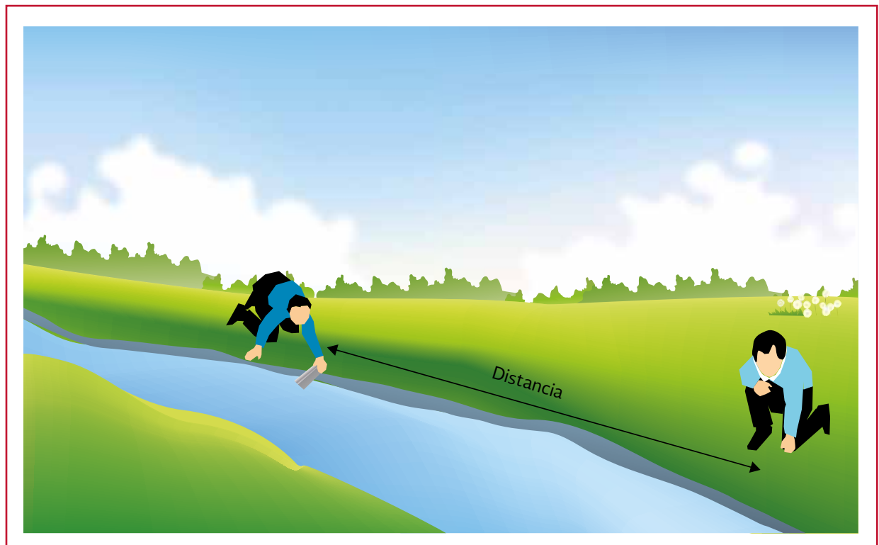
Ilustración 2.5 Método de velocidad-área
