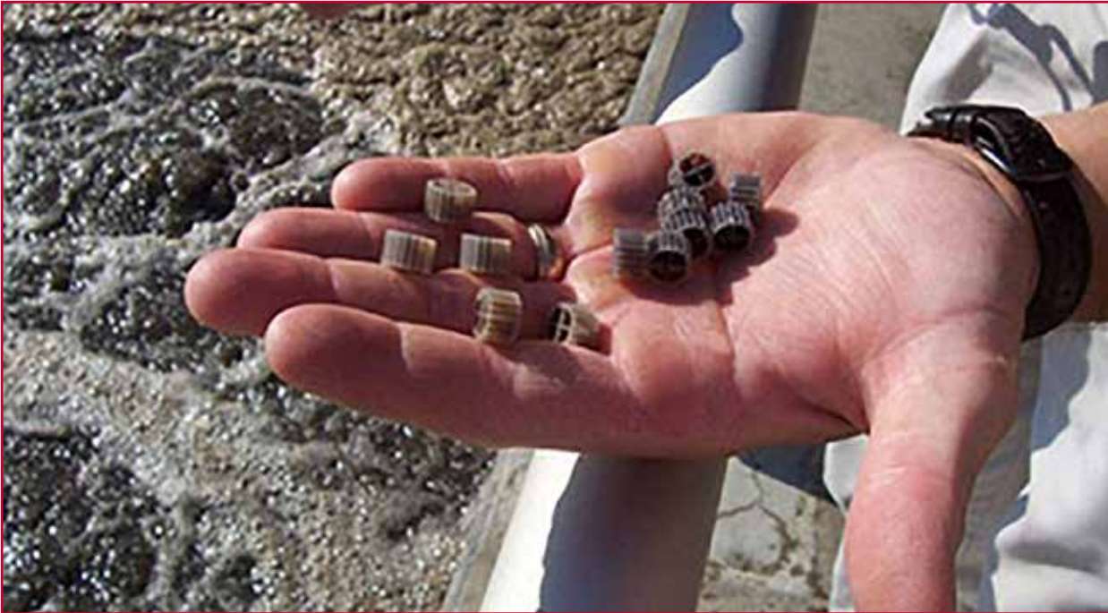
Ilustración 2.22 Medio de soporte en reactor de lecho móvil
