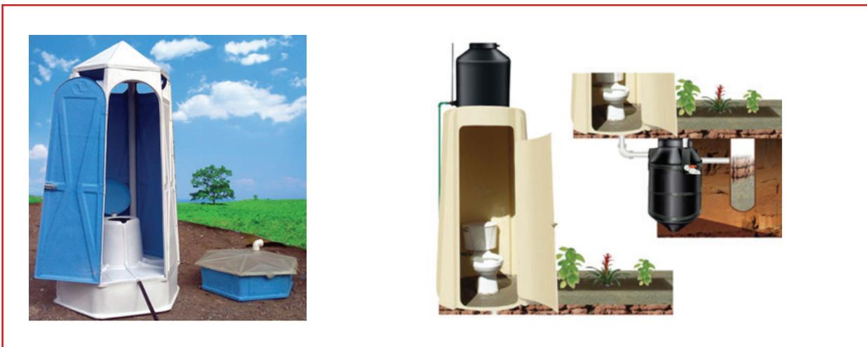
La presencia de dos cámaras tiene el objetivo de darle a las heces el tiempo suficiente para que se descompongan. El proceso es seco, utiliza cal o ceniza, y por esa razón básica desde el inicio se separan los orines.
