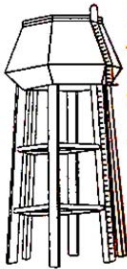
Figura 4.33 Tanque con traves rigidizantes
