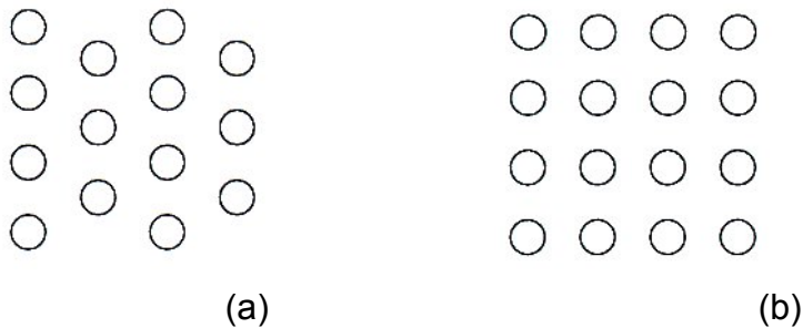
Figura 5.17. (a) Arreglo escalonado; (b) Arreglo uniforme
