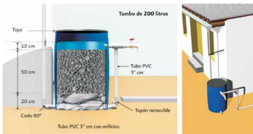
Figura 7. Filtro de grava totalmente armado.
