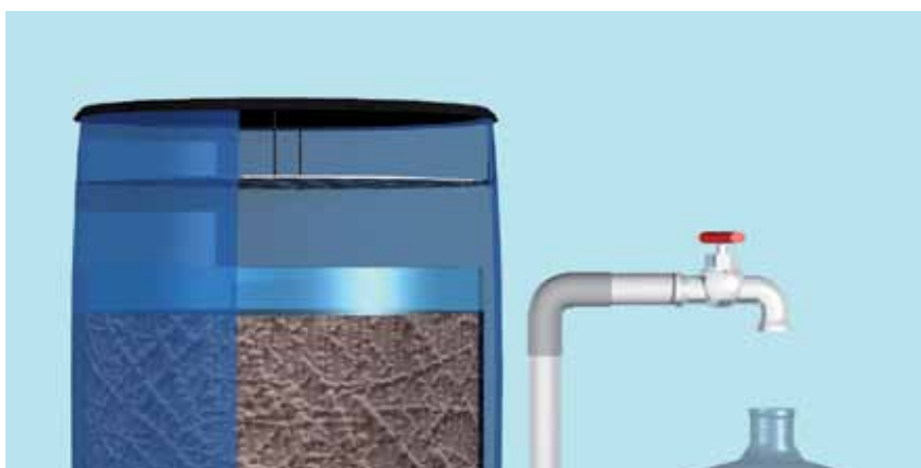
Figura 13. Nivel del agua dentro del biofiltro.
