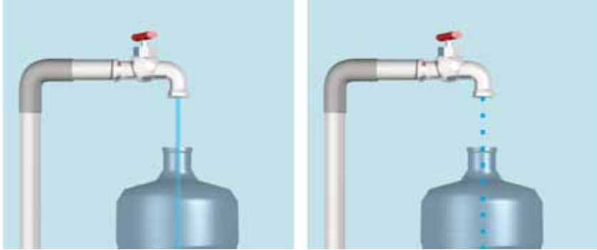
Figura 14. Filtro limpio y filtro obstruido.
