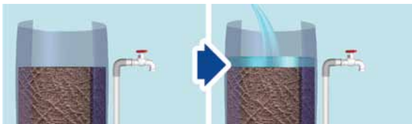
Figura 16. Remoción del agua turbia y forma de rellenar con agua limpia.
