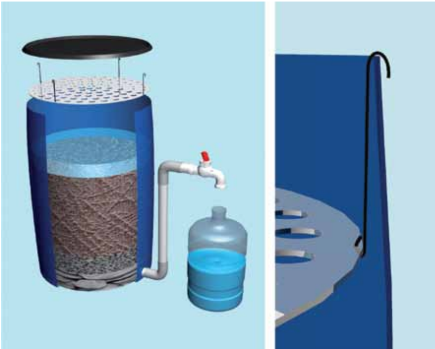
Figura 10 . Tubería con orificios para distribución de agua en el biofiltro.
