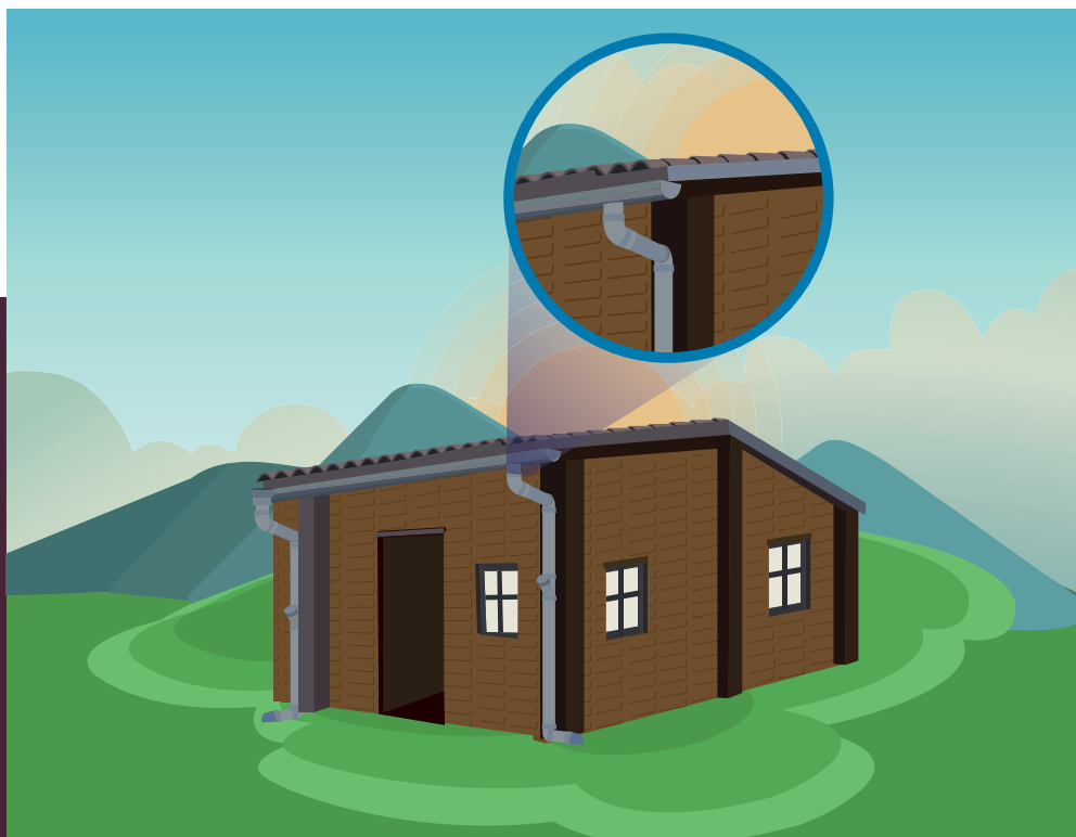
Figura 2.7. Captación de agua de lluvia.
