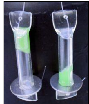
Horno solar e Indicador de Pasteurización de Agua (WAPI) (Fuente: Solar Cooker International)
