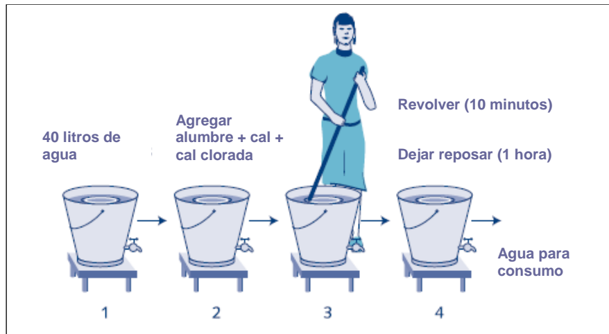
Desfluorización doméstica utilizando la tecnología Nalgonda (Fuente: Lyengar, 2002)
