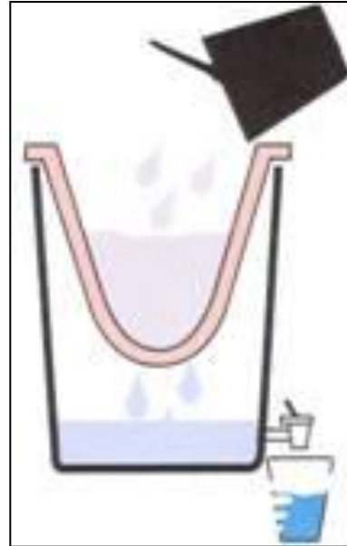
Corte transversal del filtro de cerámica tipo olla (Fuente: Filter Pure Inc)
