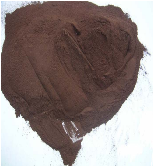
Klärschlammmasche von Fernwärme Wien
